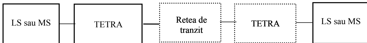
Fig. 13 Conectarea unei rețele TETRA. LS=stație de linie sau stație conectată la linie; MS=stație mobilă.
