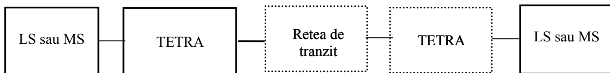
Fig. 13 Conectarea unei rețele TETRA. LS=stație de linie sau stație conectată la linie; MS=stație mobilă.
